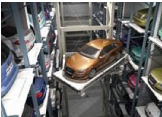
Regalbediengerät mit integrierter Drehscheibe schwenkt das Fahrzeug während der Förderbewegung und bringt es in die Ausfahrposition zurück.
