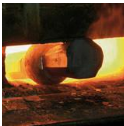
Aufwärmen im Schmiedeofen; Schmieden des Klöppels (v.l.n.r.).
